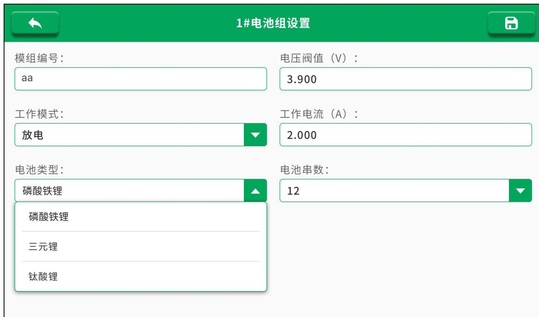
4) 电池串数：点击下拉菜单选择测试电池组相应的单体串数。
