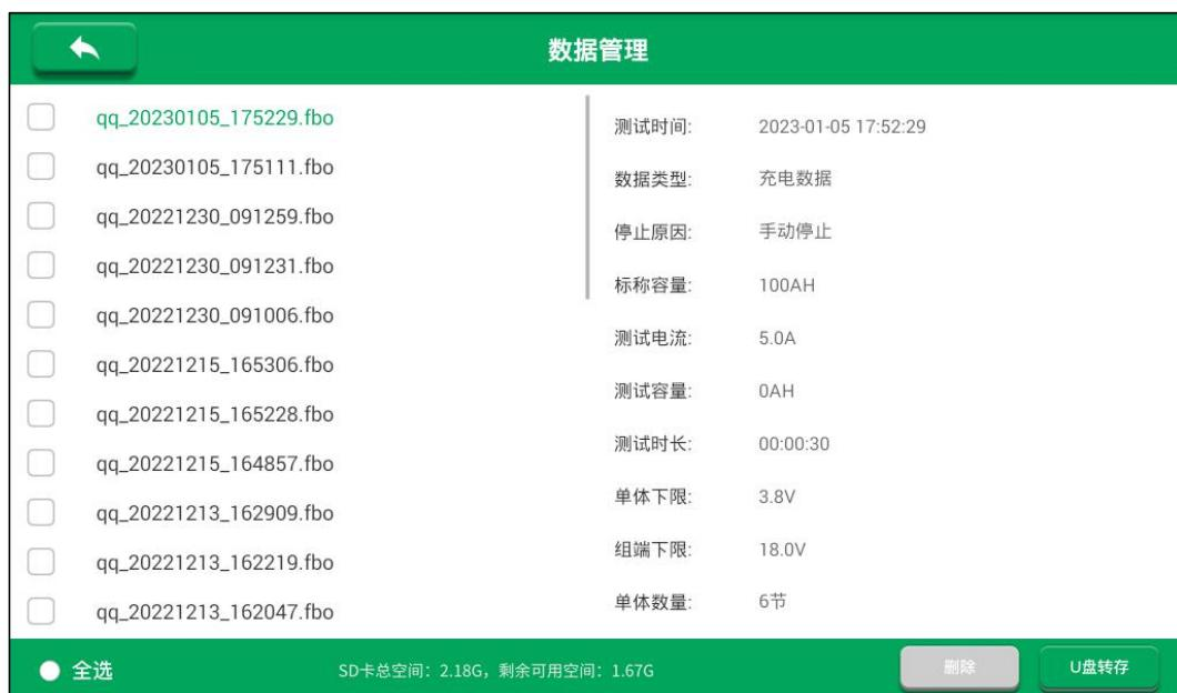
将U盘插入面板上USB口，择要保存的数据，点击U盘转存键可将对应的放电数据和充电数据转存至U盘。
