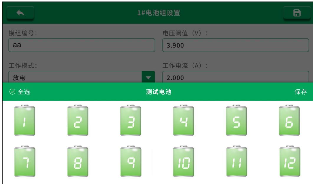
6) 电压阀值：在电压阀值项输入相应的电压值。
