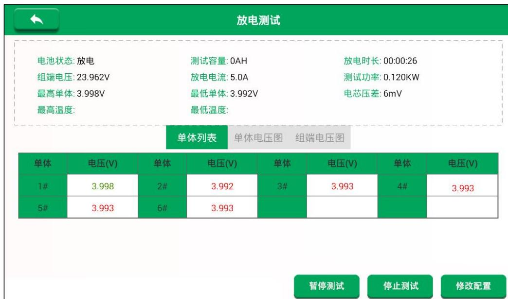
在测试的界面可以查看电池组当前状态，测试电流大小，测试时长，当前组端电压以及单体信息等。
